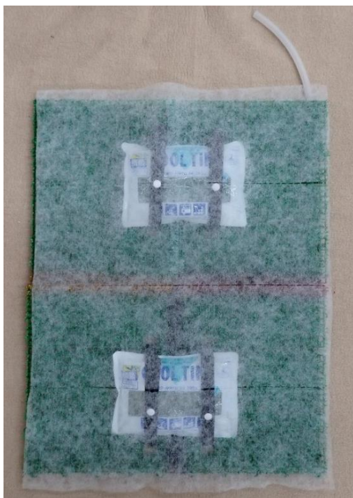
【写真3】背面冷却器（完成）
