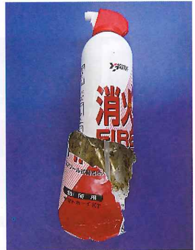
自主回収対象商品の破裂時の写真
