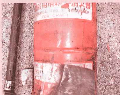
(使用に耐えない変形)
