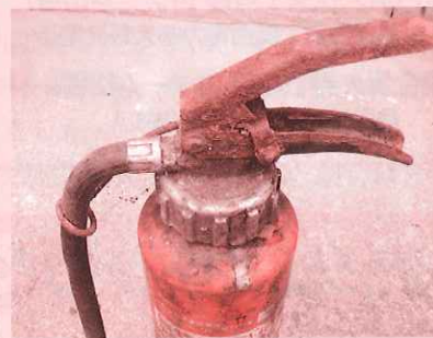
(あばた状の腐食)
